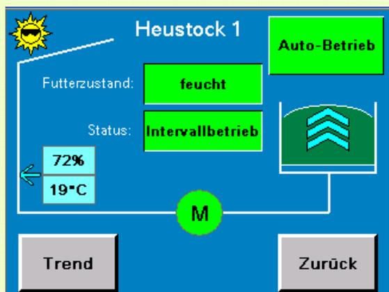
Le système HB26 peut commander jusqu'à trois ventilateurs de façon indépendante pour un volume d'air aspiré identique.
