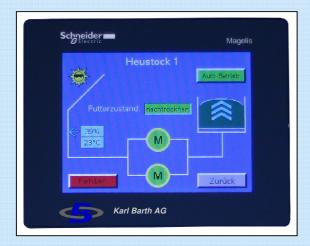
Die Heubelüftungssteuerung Secomat HB 20 kann gleichzeitig bis zu vier Heustöcke unabhängig voneinander optimal belüften.
